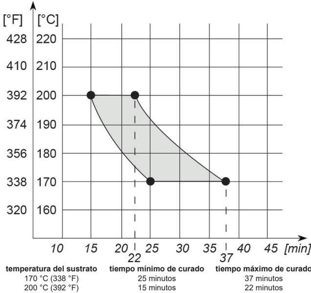
Los parámetros de curado deben ser seguidos adecuadamente debido a que las propiedades mecánicas se desarrollan antes de la polimerización (reticulación) completa.
