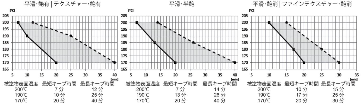
塗膜性能は塗料が完全に架橋反応する事により形成されますので、硬化条件には十分注意してください。
