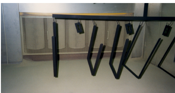
Abb. 3.5.5 Übertragung von Pulverstaub – zu nahe beisammenliegend des Pulverlackes
