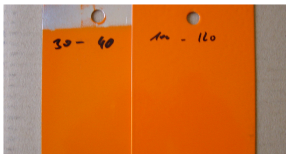
Abb. 4.1.2 zu dünne nicht deckende Lackschichten
