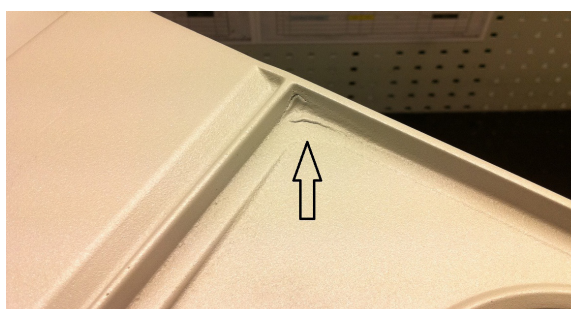
Abb. 3.7.2 Pulverlackhäufungen in Ecken durch abrieselndes
