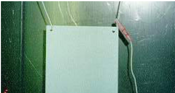
Abb. 2.3.3 Keine oder ungenügende Erdung
