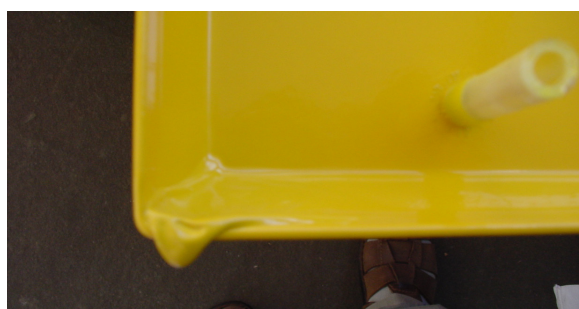
Abb. 3.7.1 Zu hohe Schichtdicke
