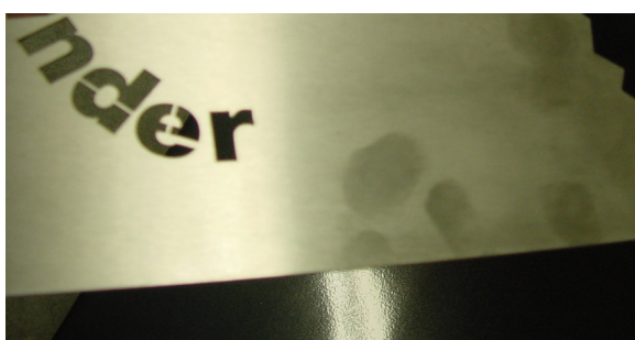
Abb. 3.2.5 Fingerprint unter farblos
