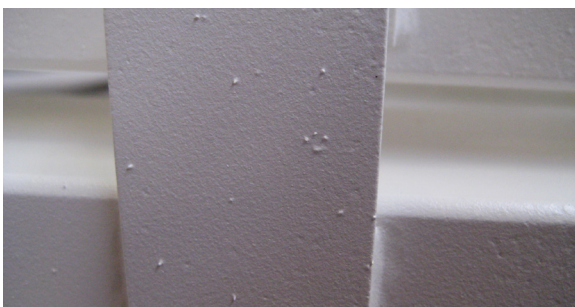
Abb. 3.1.3 Pulverspucker durch Ablagerungen an den Pistolen
