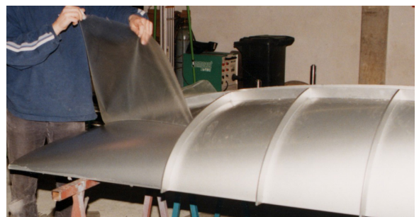
Abb. 5.2.4 Keine oder schlechte Zwischenhaftung
