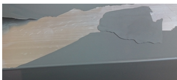
Abb. 1.1.5 Konversionsschicht zu dick
