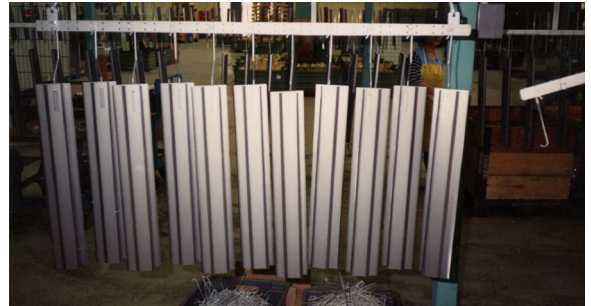
Abb. 2.4.2 Falsche Positionierung der Werkstücke
