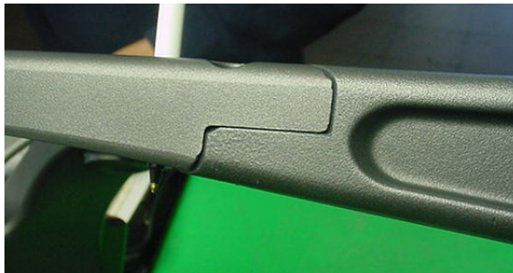
Abb. 7.3.1 hell-dunkel Abweichungen auf den Werkstücken
