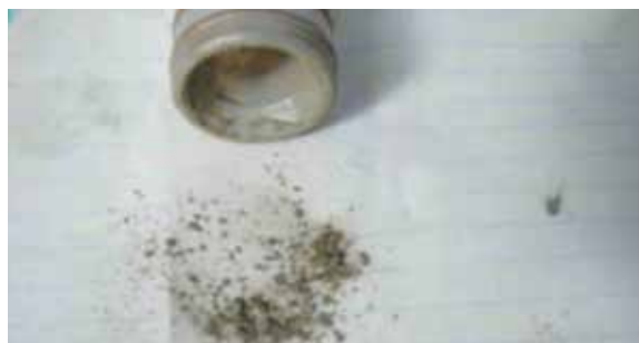
Fig. 3.1.2 Sinterización en la pistola de pulverización
