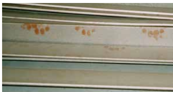
Fig. 3.2.6 Huellas dactilares de la crema de manos
