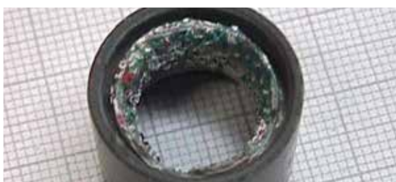
Fig. 2.2.5 Material de manguera no adecuado
