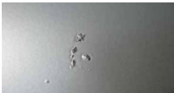
Fig. 3.1.1 Manchas de pigmento metálico
