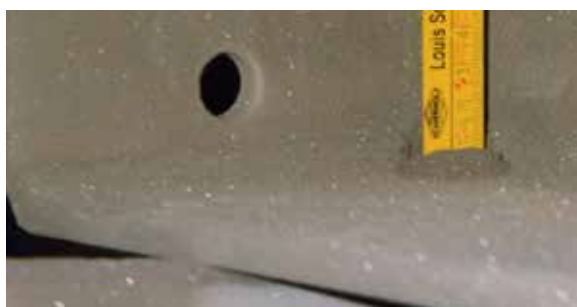
Fig. 2.3.5 Capa de polvo demasiado gruesa
