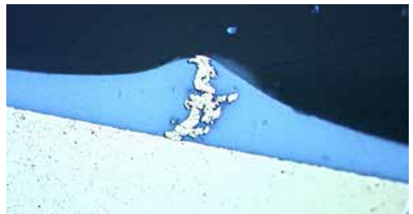
Fig. 3.5.4 Virutas en el recubrimiento
