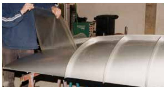
Fig. 5.2.4 No hay adhesión entre capas o ésta es pobre
