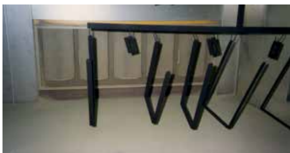
Fig. 3.5.5 Transferencia de suciedad derivada del polvo, situados demasiado cerca
