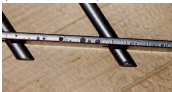
Fig. 3.2.4 Cráteres en capa de recubrimiento en polvo debido a la corrosión
