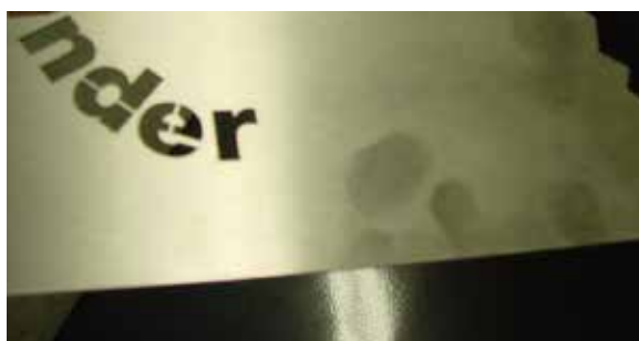
Fig. 3.2.5 Huellas dactilares por debajo del barniz
