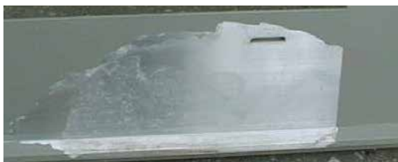
Fig. 1.1.1 Pretratamiento de cromatizado de conversión pobre
