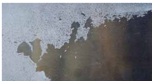
Fig. 3.8.1 Grandes áreas de discontinuidad que no muestran una capa de pintura
