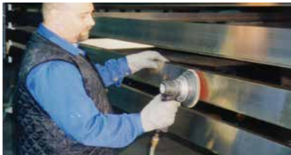
Fig. 3.5.1 Contaminación de la superficie de la pintura derivada de los trabajos de desbastado
