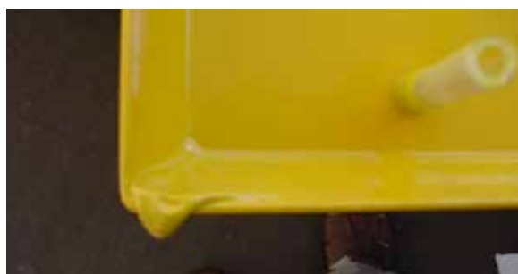
Fig. 3.7.1 Espesor demasiado elevado
