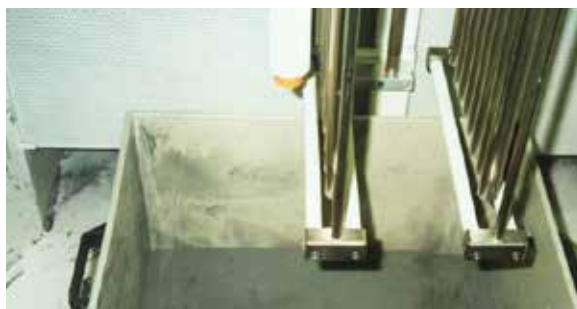
Fig. 2.1.1 Fluidización: el polvo debe fluir como el agua
