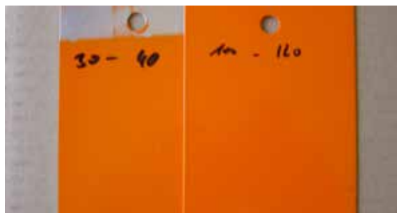
Fig. 4.1.2 Los espesores de pintura son demasiado finos y no cubren lo necesario
