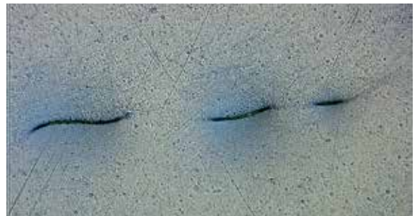
Fig. 3.5.2 Fibras y pelusas de trapos de limpieza y ropa de trabajo
