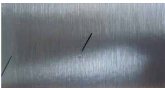
Fig. 3.5.7 Partículas de gel en el recubrimiento en polvo
