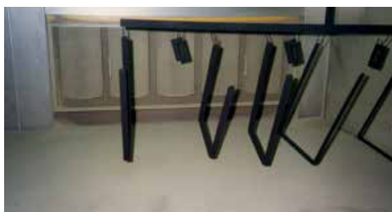
Fig. 6.1.2 Transferencia potencial de polvo de una cabina a otra; contaminación cruzada
