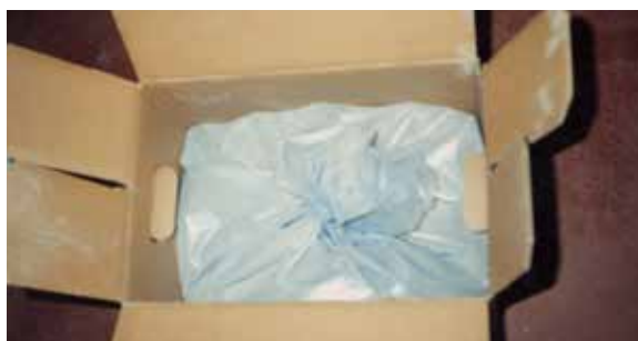
Fig. 3.5.6 Contaminación al almacenar el recubrimiento en polvo
