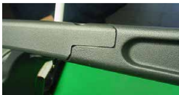
Fig. 7.3.1 Desviaciones claro-oscuro en piezas de trabajo
