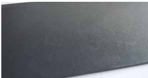
Fig. 3.2.7 Enjuague pobre con chorro de arena, e-coat de base
