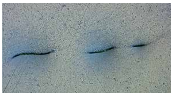
Fig. 3.5.2 Fibres, peluches venant des chiffons et des vêtements de travail
