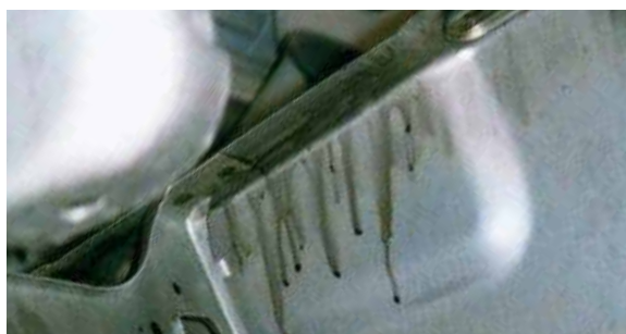
Fig. 1.3.2 Lubrifiants d'emboutissage résistant au prétraitement
