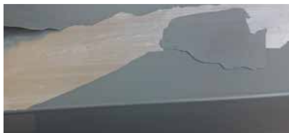
Fig. 1.1.5 Couche de conversion trop épaisse
