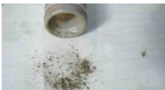
Fig. 3.1.2 Agglomérat dans le pistolet d'application
