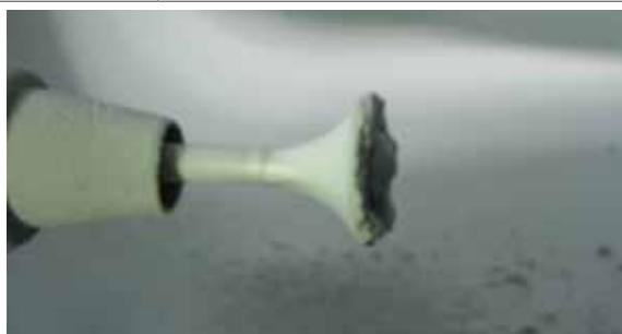
Fig. 2.2.1 Pression de l'air de transport trop élevée, remplacer par « Agglomérat au niveau de la buse d'application plate » Fig. 2.2.2 Rapport de particules fines de la poudre trop élevé, remplacer par « Agglomérat au niveau du broyeur à impact »
