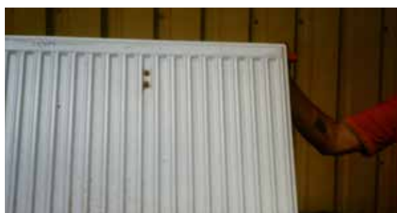
Fig. 5.2.2 Prétraitement insuffisant ou inadéquat
