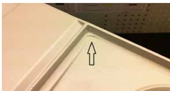
Fig. 3.7.2 Accumulation de poudre ayant ruisselé dans des coins
