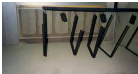
Fig. 6.1.2 Éventuel transfert de poudre entre deux cabines – Contamination croisée
