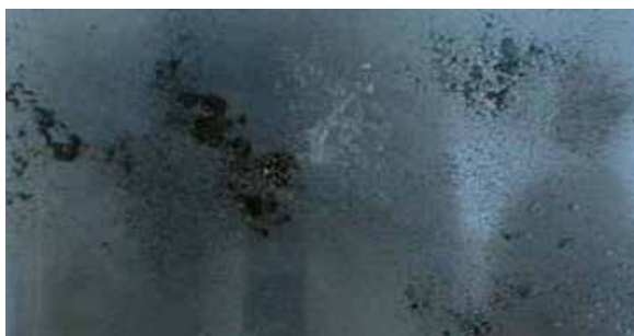
Fig. 1.3.1 Résidus de graisse après prétraitement
