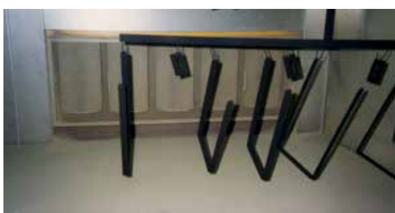
Fig. 3.5.5 Transfert de poussière de poudre - Installations trop proches
