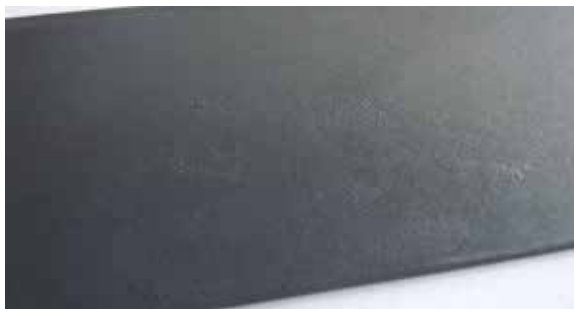
Fig. 3.2.7 Rinçage insuffisants de surface décapées au sable, revêtement par cataphorèse comme prétraitement
