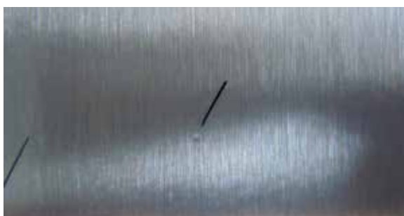
Fig. 3.5.7 Particules de gel dans le revêtement en poudre
