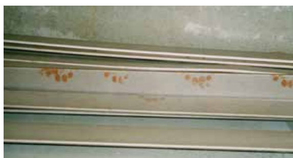
Fig. 3.8.2 Contamination des pièce par de la sueur, de la crème pour les
