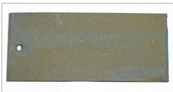
Fig. 1.3.5 Corrosion liée au revêtement de phosphate de fer sur pièces décapées au sable après prétraitement
