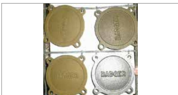
Fig. 1.3.6 Corrosion de pièces décapées au sable
