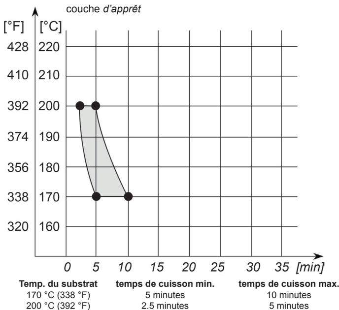
Les paramètres de cuisson doivent être suivis de manière précise puisque les propriétés mécaniques se développent avant la réticulation complète.
